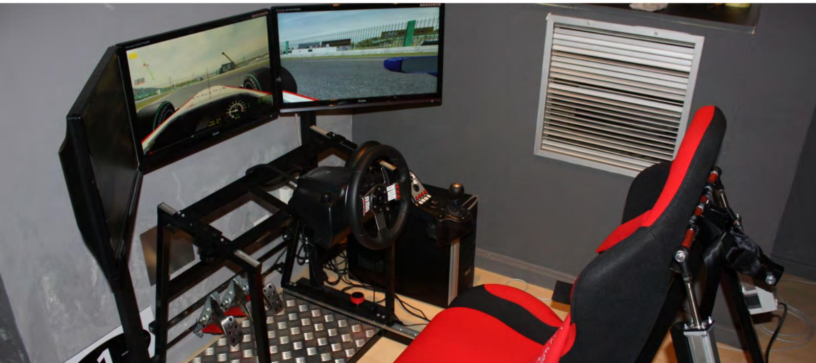
Derrière le volant, trois moniteurs captent le regard. Et, sur le côté, une unité centrale. Celle-ci accueille un processeur Intel Core i5 et une carte graphique ATI 5870 accouplée à un boîtier Matrox qui gère le triple écran. L'unité centrale est reliée au boîtier SimXperience chargé de mettre en mouvement les deux vérins.
