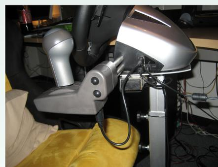
Le shifter séquentiel Fanatec et sa connectique « originale » de type PS2 qui n'est, à mon avis, pas le choix le plus judicieux. En mode « PC » vous pourrez utiliser le plus moderne USB. A noter que sur le côté gauche du boîtier du volant se trouve la prise qui permet de brancher le casque Microsoft de la xBox 360.
