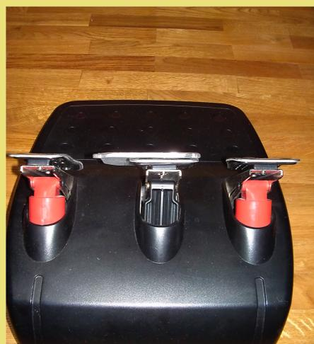
La cellule de capteur de pression est en place dans le pédalier du G25. On remarque également l'épaisseur de la plaque d'aluminium sur la pédale de frein. Cette épaisseur peut être adaptée selon les goûts. [www.apelectrix.com](http://www.apelectrix.com)
