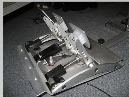
Vu de l'arrière le pédalier Clubsport vous montre ses possibilités d'ajustement. Vous remarquerez le potentiomètre de limitation du frein, les écrous de précontrainte des ressorts et l'ajustement en hauteur de l'angle d'attaque de chaque pédale.
