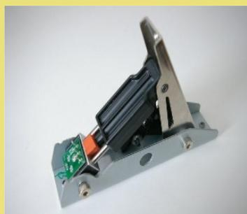
La Cellule de pression dans son support pour le pédalier du G25. Cette pièce va remplacer le cylindre rouge qui contient les ressorts d'origine.
