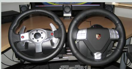
On notera le diamètre différent des deux volants, la finition alu du G25 et les palettes de changement de vitesse bien en vue sur le Logitech. Notez la présence du bouton « Xbox » en arrière plan sur la gauche du volant Fanatec.
