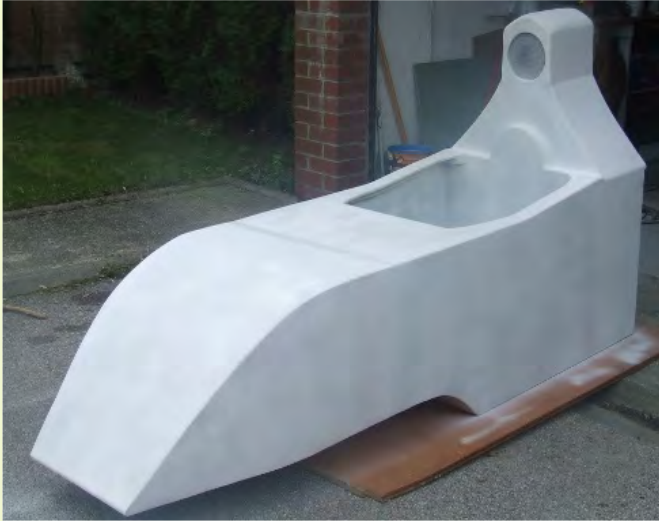
Après la pose de 3 couches d'apprêt
