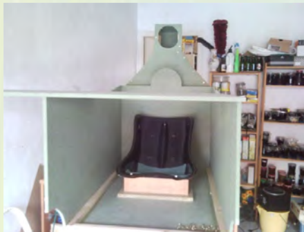
Pose des structures en bois (medium dit MDF, le siège de kart me sert de gabarit
