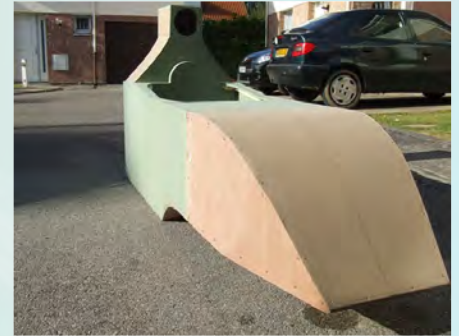
La partie avant est réalisé en contre-plaqué 3 mm
